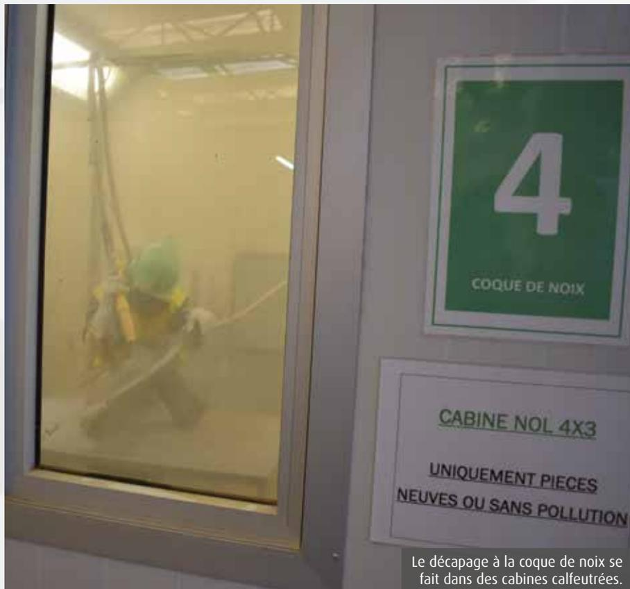
Le décapage à la coque de noix se fait dans des cabines calfeutrées.
