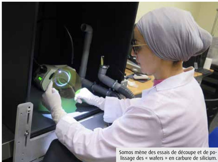
Somos mène des essais de découpe et de polissage des « wafers » en carbure de silicium.
