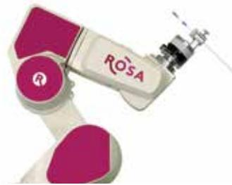
D'une précision rare, le robot Rosa est utilisé pour implanter des électrodes de neurostimulation dans le cerveau des patients atteints de la maladie de Parkinson. Il est aussi adapté à la pose de vis et d'implants dans le cas de pathologies lombaires.
