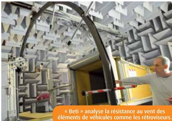
« Beti » analyse la résistance au vent des éléments de véhicules comme les rétroviseurs.
